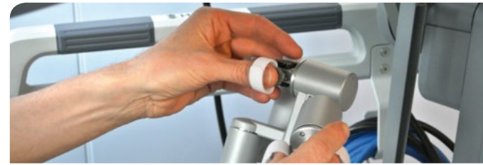
Master Controller für die Übertragung der Handbewegungen
