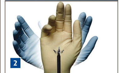
Die da Vinci Instrumente sind über 540° drehbar und verfügen über sieben Freiheitsgrade. (© Intuitive Surgical)
